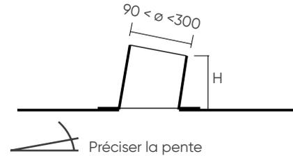
Des diamètres supérieurs, moyennant une pose sur plusieurs plaques de Mauka® Line 1.450.36T, sont réalisables : n'hésitez pas à nous consulter pour une plaque à douille CMPD11GD !
